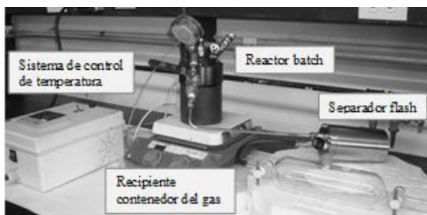
Figura 1: Reactor batch para la pirólisis de los asfaltenos
